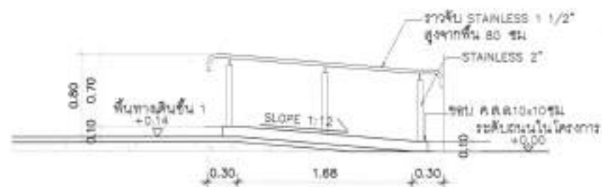
แบบขยายรูปตัด B มาตราส่วน 1:50A1
