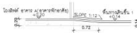
แบบขยายรูปตัด D มาตราส่วน 1:50A1
